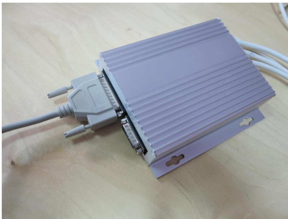
Рисунок 4. Подключение интерфейсного кабеля к контроллеру станка
