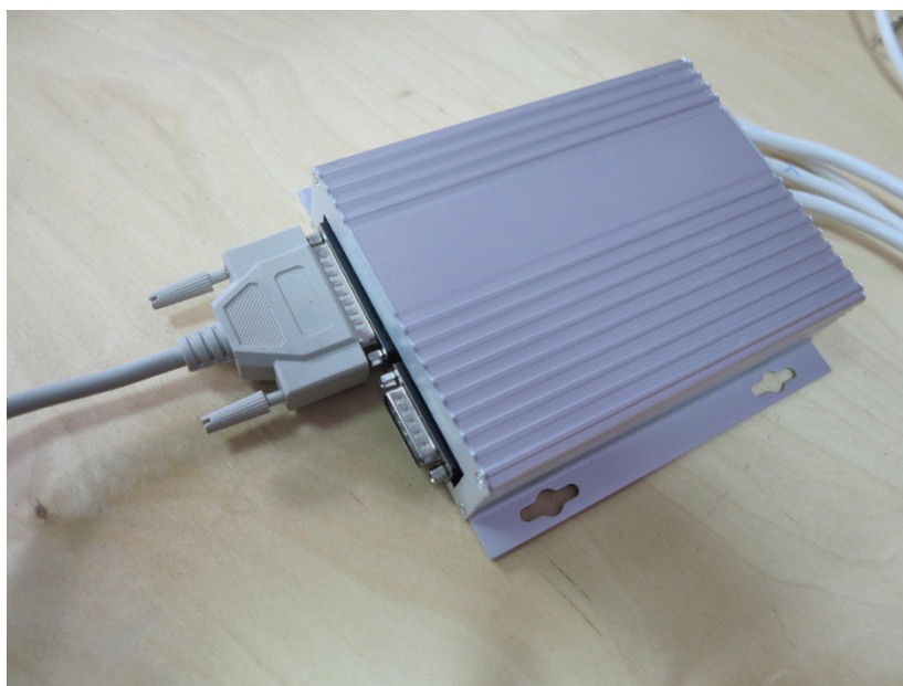
Рисунок 3. Подключение интерфейсного кабеля к контроллеру станка
