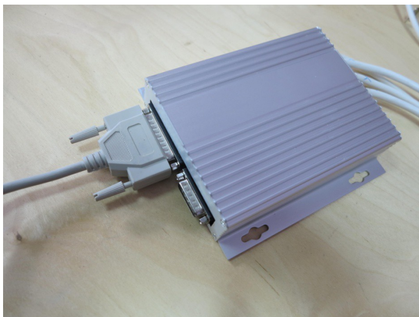
Рисунок 3. Подключение интерфейсного кабеля к контроллеру станка
